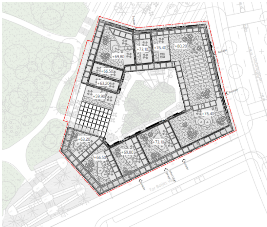
Figur 6. Byggnadens höjder, från +80,20 i nordöstra hörnet i Forum ner till + 59,90 mot parken.
